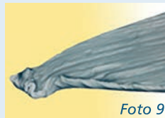
Foto 46: 370-fache Vergrößerung einer unbenutzten Nadel Foto 8: 370-fache Vergrößerung einer wiederverwendeten Nadel Foto 9: 2000-fache Vergrößerung von Nadel des Fotos Nr. 8
